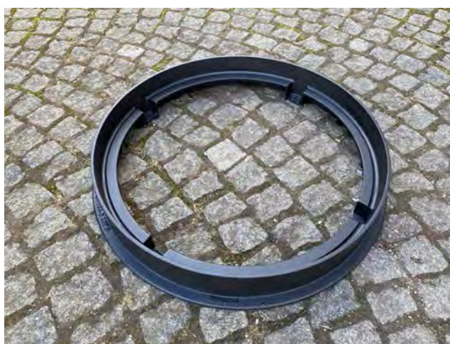
Art.: 19620 Schachtabdeckungen "Windrose" rund DN600 ohne Ventilation. D 400 kN Rahmen aus Gusseisen, Deckel aus Gusseisen mit einer Bronzauflage braun patiniert Deckel Lichte Weite: 610 mm
